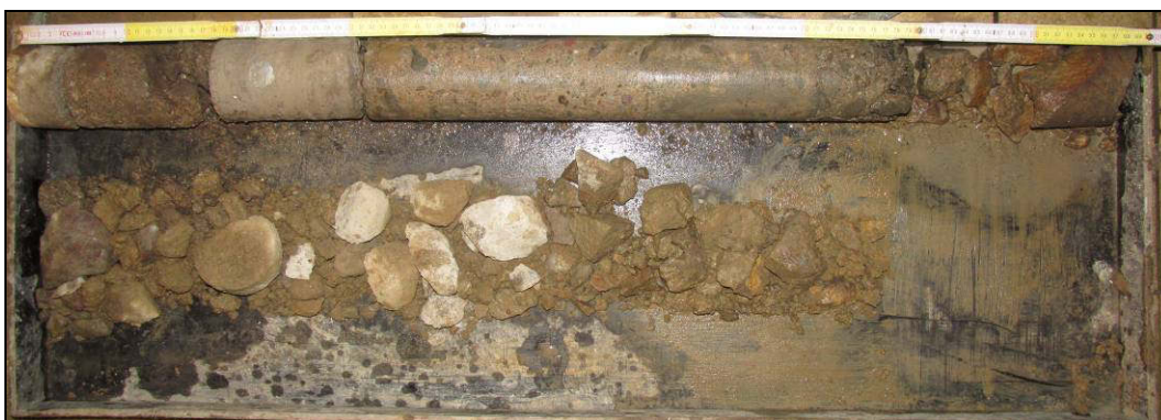
Obr. č. 2 - diagnostický vrt S1 - základ podchodu u opěry Maloměřice
