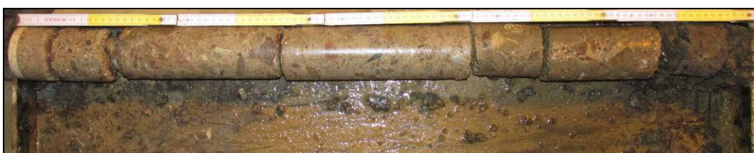
Obr. č. 4 - diagnostický vrt S2 - základ podchodu u opěry Kuřim
