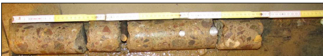
Obr. č. 6 - diagnostický návrť N2 - nosná konstrukce pod kolejí č. 1
