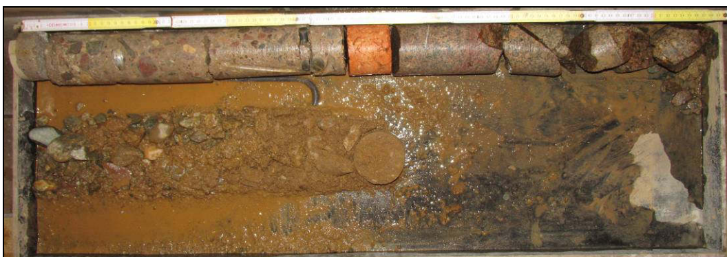
Obr. č. 3 - diagnostický vrt V2 - opěra Kuřim
