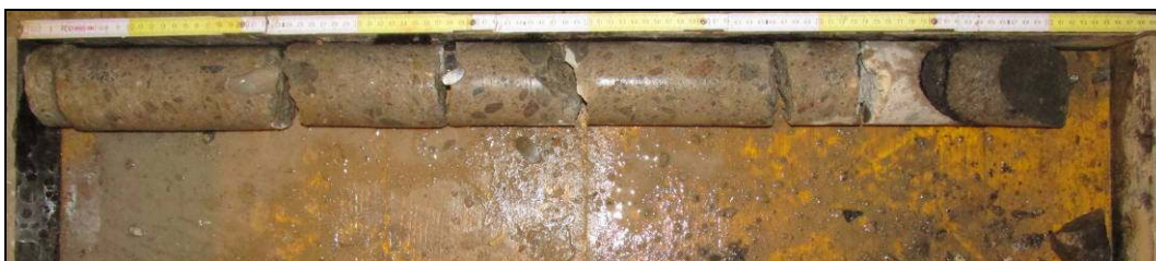
Obr. č. 5 - diagnostický návrť N1 - nosná konstrukce pod kolejí č. 5
